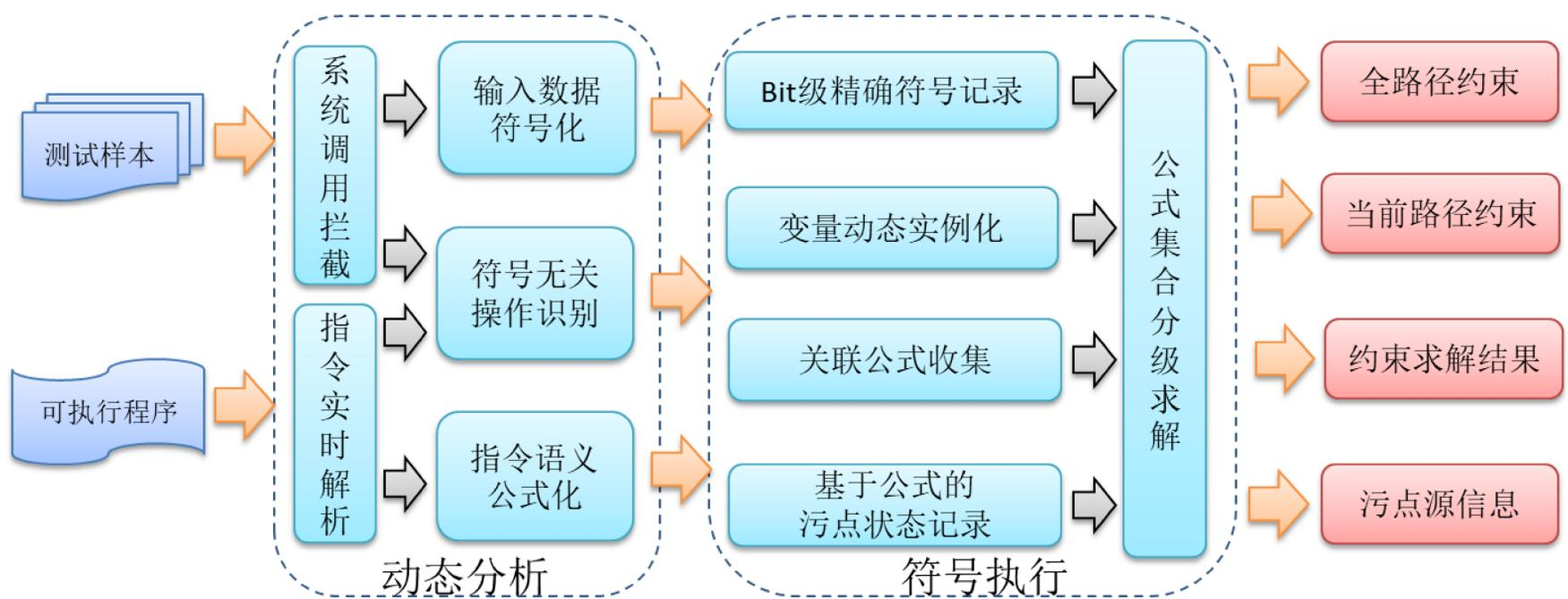
系统基于Pin插桩实现，主要包括指令动态提取、输入数据符号化、关联逻辑公式收集、公式集合分级求解、符号数据源回溯等功能，具备针对Linux、Windows等操作系统上的大型应用程序的动态逆向分析能力。系统具有如下的技术特性：
